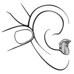
Tirez doucement sur votre oreille et poussez l'aide auditive dans le conduit auditif en le faisant tourner légèrement si nécessaire. Suivez le contour naturel du conduit auditif. Poussez l'aide auditive pour s'assurer qu'elle s'adapte confortablement dans l'oreille.
